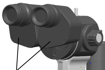
Нахиліть основу бінокулярних трубок на обидві сторони
